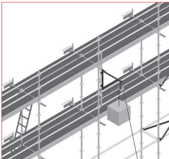
Рис. 3.79 – Леса с подъемником
