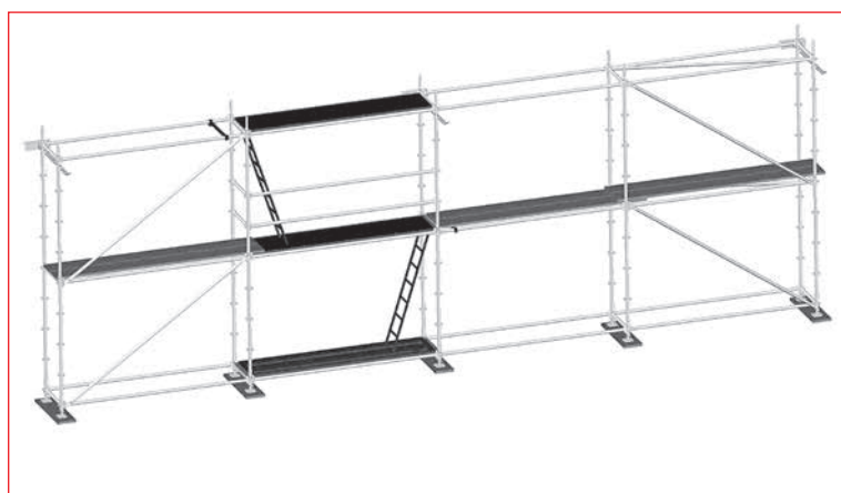
Рис. 3.59 – Пример анкеровки лесов до очередного подъема
