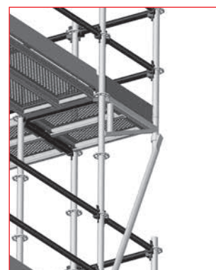
Рис. 3.25 - Угол, выполненный при помощи трех стоек, опоры и связи (см. рис. 3.28)
