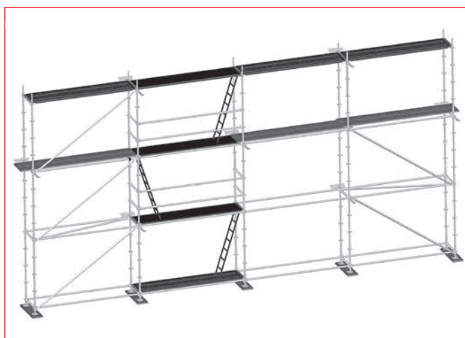
Рис. 3.61 – Рабочий и защитный настил, оборудованный связями
