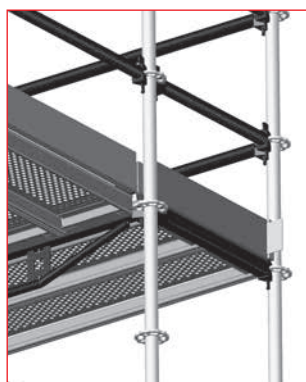
Рис. 3.24 – Угол, сделанный при помощи двух стоек
