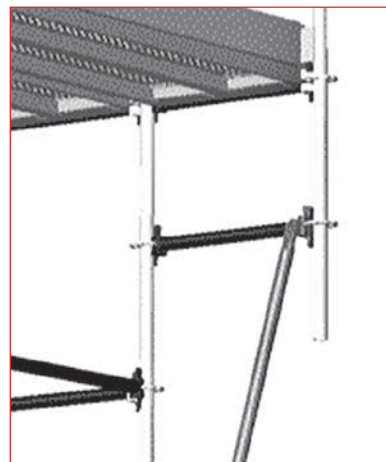
Рис. 3.29 – Расширение при помощи ригелей и связей
