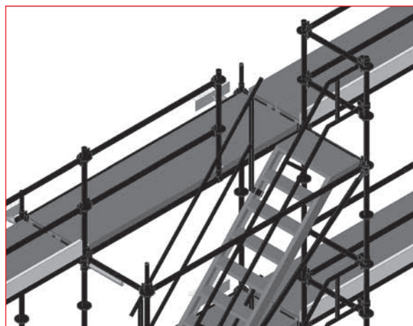
Рис. 3.78 – Выход с лестницы, пример № 2
