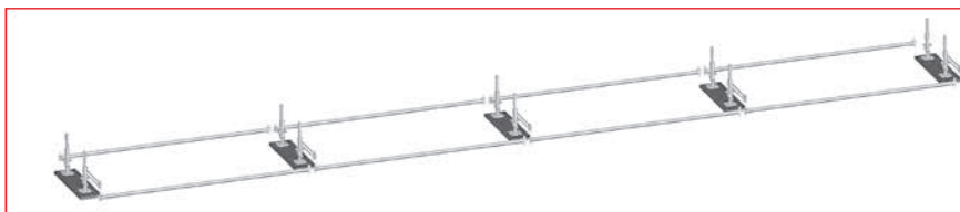
Рис. 3.53 - Этап 2 – Установка начальных элементов
