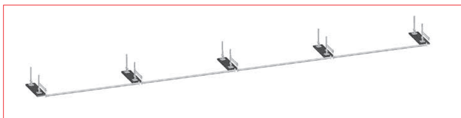
Рис. 3.52 - Этап 1 – Монтаж подставок
