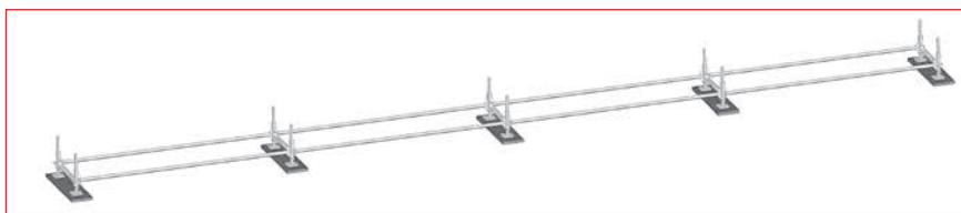
Рис. 3.54 - Этап 3 – Скрепление начальных элементов
