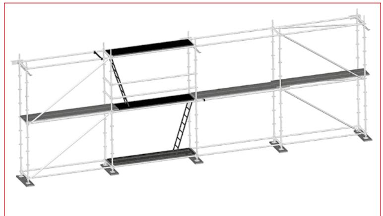
Рис. 3.59 – Пример анкеровки лесов до очередного подъема
