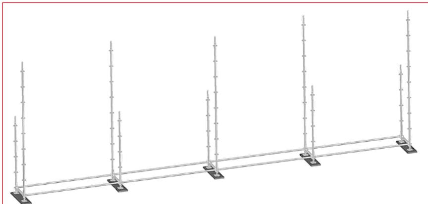
Рис. 3.57 – Пример использования стоек разной длины
