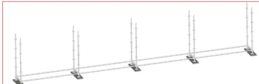
Рис. 3.56 – Пример использования одной длины стоек
