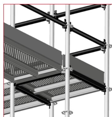
Рис. 3.26 – Угол, выполненный при помощи четырех стоек
