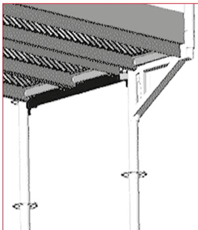
Рис. 3.27 – Расширение с помощью кронштейна 0,36м
