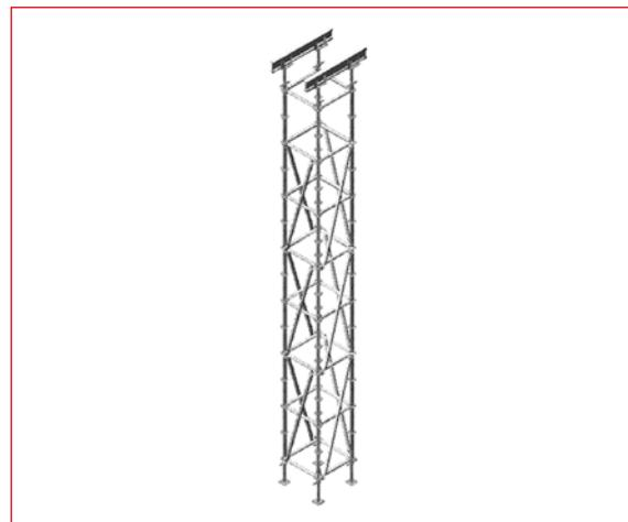
Рис. 3.64 - Леса ROTAX Plus в башенном исполнении
