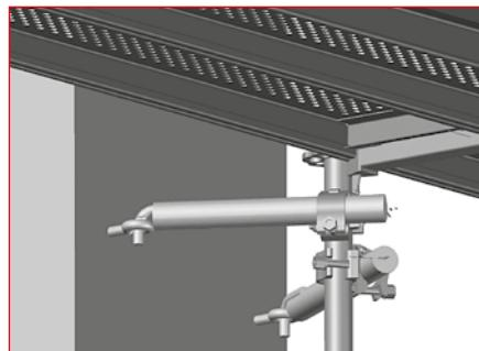
Рис.3.31 - Анкеровка внутренних стоек анкером типа V
