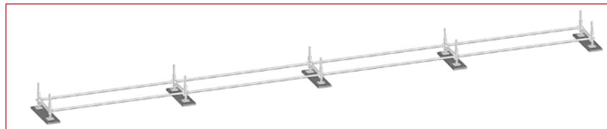
Рис. 3.54 - Этап 3 – Скрепление начальных элементов
