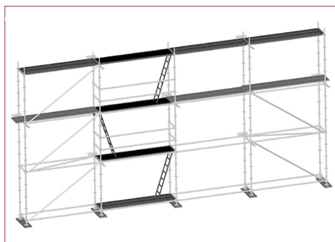
Рис. 3.61 – Рабочий и защитный настил, оборудованный связями
