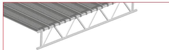
Рис. 3.37 – Монтаж траверса на ферме
