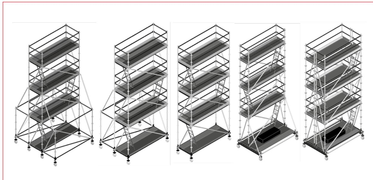
Рис. 3.71 – Передвижные леса в разных конфигурациях
