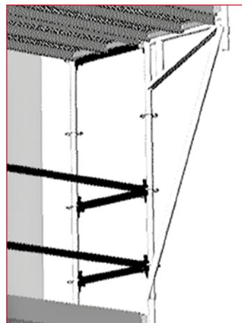
Рис. 3.28 – Расширение с помощью опоры 0,73 м и связи
