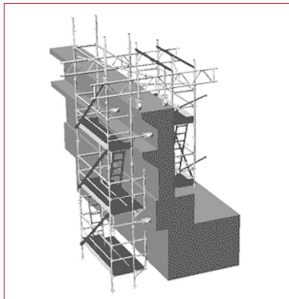
Рис. 3.69 – Способ монтажа подвесных строительных лесов
