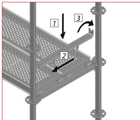
Рис. 3.17 – Пример монтажа настилов на U-ригелях
