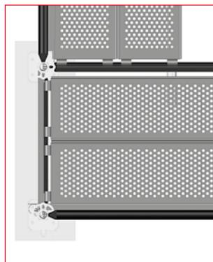
Рис. 3.24 – Угол, сделанный при помощи двух стоек
