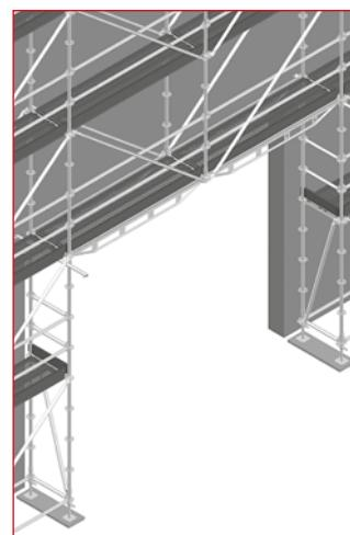
Рис. 3.36 Арочный проезд с опорой на двойных ригелях
