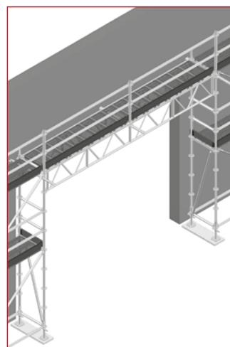
Рис. 3.35 Арочный проезд с опорой на фермах
