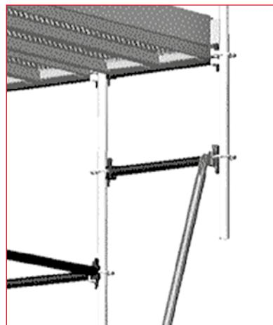
Rys. 3.29 – Расширение при помощи ригелей и связей
