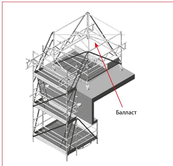
Рис. 3.68 – Способ монтажа подвесных строительных лесов
